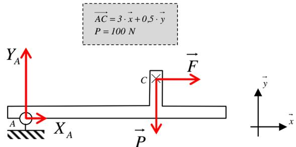
$$\vec{A} \begin{vmatrix} X_A \\ Y_A \\ 0 \end{vmatrix} \quad \vec{P} \begin{vmatrix} 0 \\ -100 \\ 0 \end{vmatrix} \quad \vec{F} \begin{vmatrix} X_F \\ 0 \\ 0 \end{vmatrix}$$
